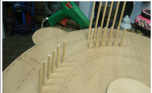
22. Després de tallar-los començarem a enganxar-los sobre la base i en els forats dels anells. Això ho farem per quarts
