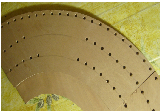
19. En les marques dels pilars dels anells fent els forats per a fer més fàcil la construcció
