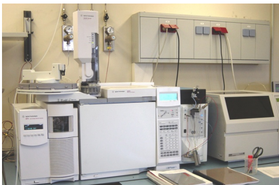
Imatge 4. Cromatògraf de gasos amb mostrejador headspace i sistema de loop pressuritzat.
