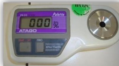
Imatge 17. (SS) Refractòmetre digital AtagoPatette 100 (X.Mas)
