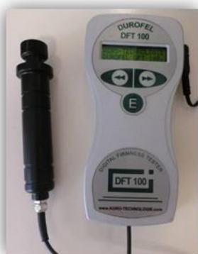
Imatge 19. (Fermesa) Texturòmetre Durofel DFT 100 (X.Mas)
