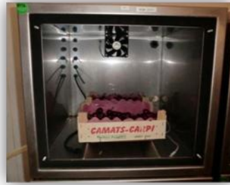
Imatge 14. Microcambra centre UdL-IRTA per a l'aplicació dels xocs CO 2 (Fotografia X.Mas)
