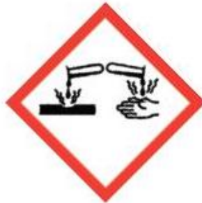
Corrosiu pels metalls i corrosió cutànea
