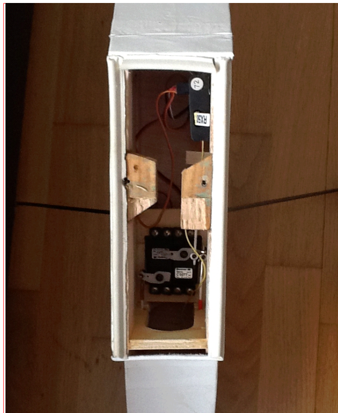
Imatge 12: Vista detalla l'interior del fuselatge, sota les ales. Es veu el receptor a la part superior i els servomotors en la inferior.
