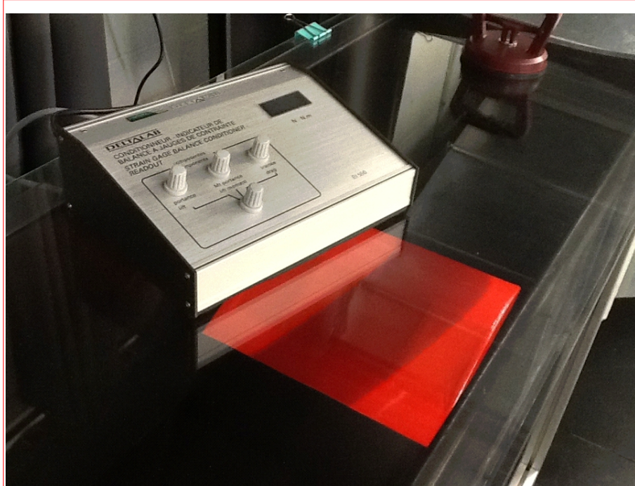
Imatge 3: Ala amb el dispositiu que registrava les forces al túnel de la UdG
