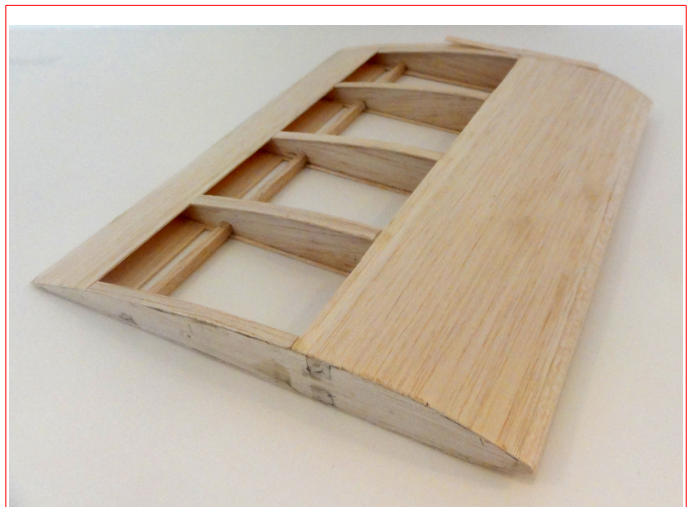
Imatge 14: Maqueta inacabada de l'ala per l'UdG
