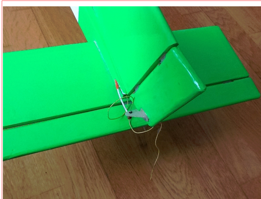
Imatge 13: Vista detallada de la cua de l'avió. Es veu el sistema de gir dels alerons i la punta de l'antena que surt a l'exterior (el cable groc).
