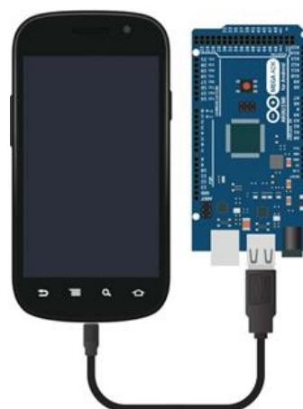
Il·lustració 14 Arduino comunicant-se amb Android
