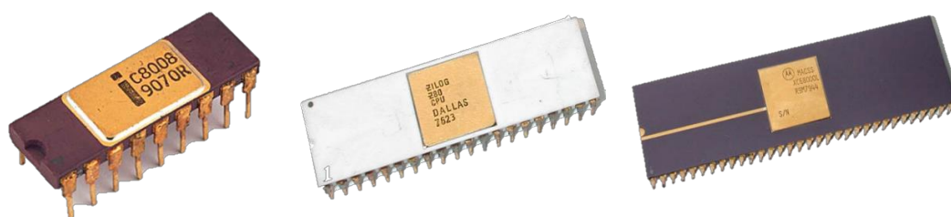
Il·lustració 6 Intel 8008, Zilog Z80, 68000 de Motorola
