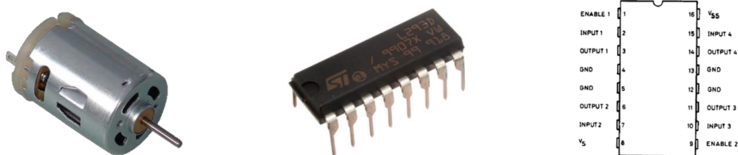
Il·lustració 26 Exemples de Motor CC, driver 293 i les entrades del driver
