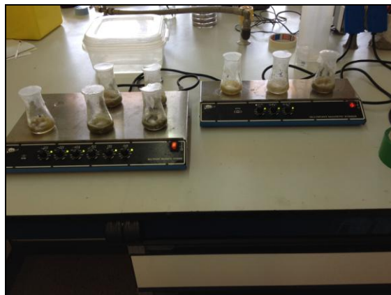
Imatge 42: Agitador de mostres amb els erlenmeyers d' A. flavi remenant el seu contingut
