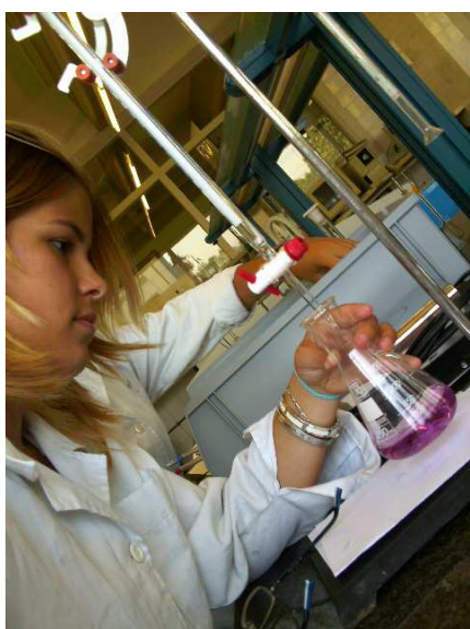
Figura 6: introducció d'EDTA a la solució.
