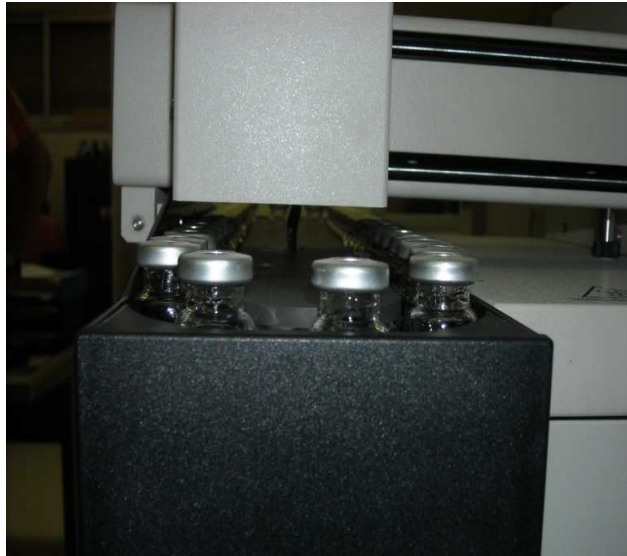
Figura 11: analits preparats per la injecció a l'interior del cromatògraf de gasos.
