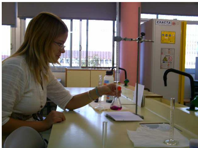
Figura 23: Preparació de la solució amb EDTA al laboratori del institut.
