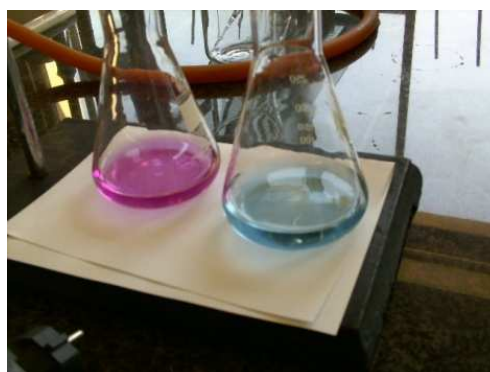
Figura 7: solució insaturada(a l'esquerra) i saturada d'EDTA (a la dreta).
