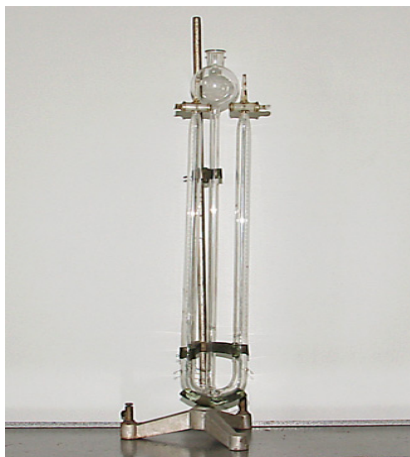
Figura 15: Voltàmetre de Hoffman
