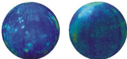
Imatge II: Mapes topogràfics del grossor de les capes de diòxid de silici ( \text{SiO}_2 ). L'esfera de l'esquerra és l'anomenada AVO28-S5 i la de la dreta, AVO28-S8. El color blau indica un gruix de 2,0nm i el groc de 4,5nm.
