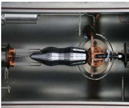
Imatge 1: Procés de purificació d'una de les dues esferes de silici fabricades expressament per a aquest experiment.
