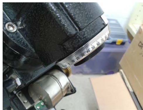
Cercle graduat de l'eix equatorial Muntura equatorial de l'INS Alcarràs
