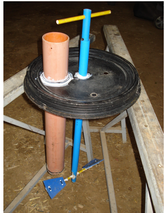
Remenador per incrementar la quantitat de biogàs.
