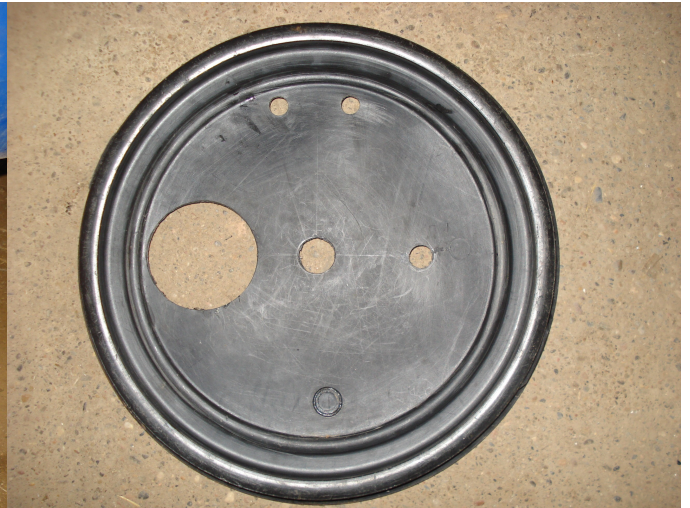
Perforació de la tapa del digestor. (Enartada de purí (forat gran), sortida gas (forat petit) (remenador (forat central) i tubs calefacció (forats a part)).
