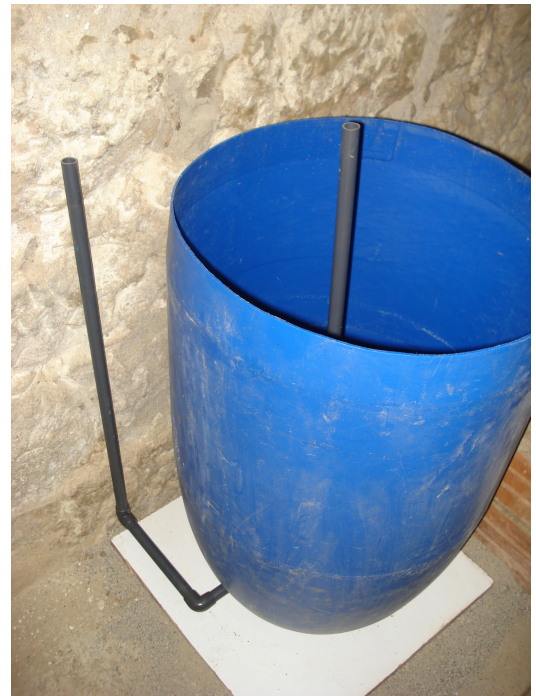
Circuit d'inserció del gas a l'acumulador.
