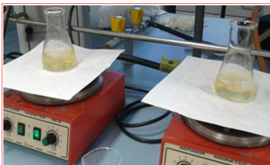
Ilustración 1: Fotografía de una tándem de dos reacciones con agitación magnética. Elaboración propia. Fecha: 25-09-2012.
