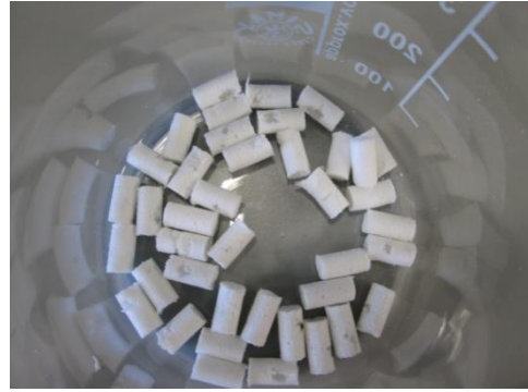
Imatge 11. Scaffolds de PLA
