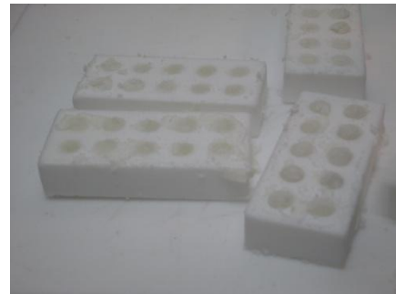
Imatge 12. Barreja de PLA, cloroform i sal en els motlles
