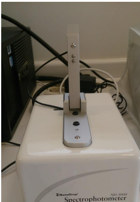
FIG. 22. Aquest és l'espectrofotòmetre on s'ha de carregar la mostra per tal que pugui ser llegida pel programa de lectura d'ordinador ND-1000 V3.5.2.
