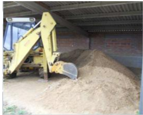
Imatge 18 Terres argiloses de Planes d'Hostoles, emprades per la construcció del BTC. 24
