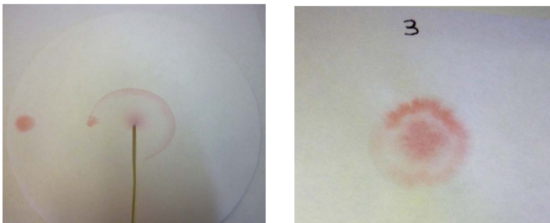
Fig. 7.6. Desenvolupament dels components de l'extracte de tomàquet en cromatografia en paper. Eluent: acetona
