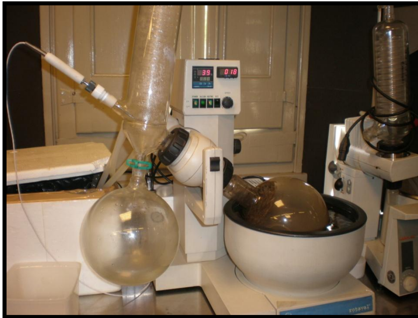
Imatge 37. Rotaval, màquina per destil·lar. En aquest cas el que es destil·la és terra.
