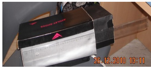
Muntatge de la cambra fosca amb un regle per mesurar la longitud
