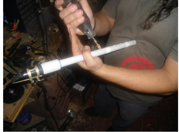
Imatge 38. En Xavi foradant el clarinet on ja es poden veure dues tires de cinta aïllant.
