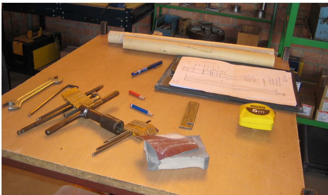
El boix que treballarem s'ha de tornejar de tal manera que quedi un cilindre perfecte.
