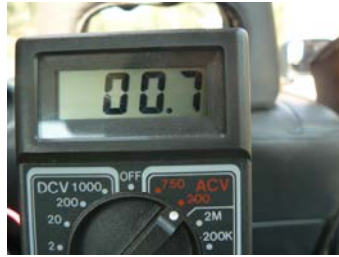
Fig. 68. Mesura d'un voltatge
