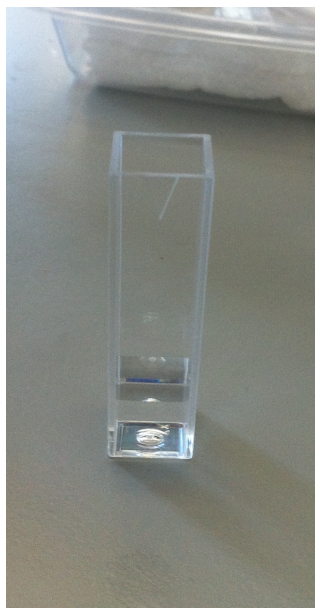
Figura 28: Cubeta de vidre específica per al ZetasizerNanoZS
