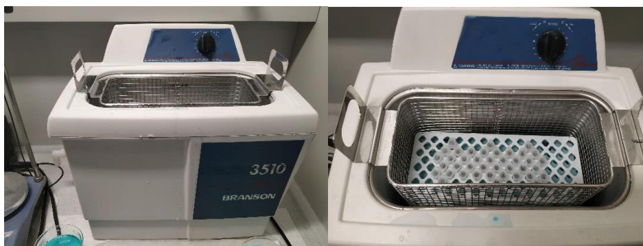
Figura 26. Ultrasons emprat en la fase d'extracció.
