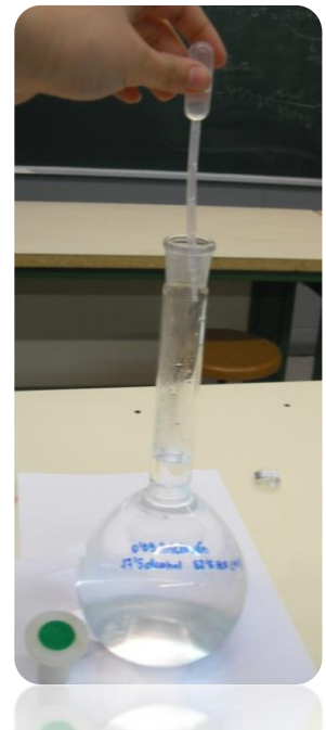
38 Imatge de la dissolució amb Triclosan, afegint amb un comptagotes la dissolució per arribar a la línia coll. Font: Elena Marín.
