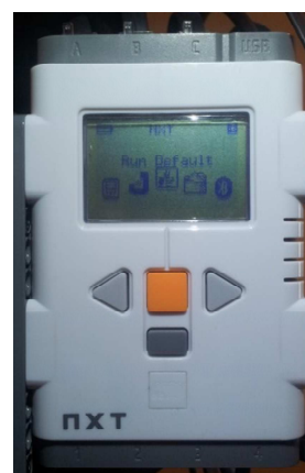
Fig 4.7. Firmware LeJOS a un NXT 2.0.
