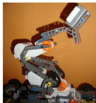
Fig 5.9. Grua amb mòdul de reducció.
