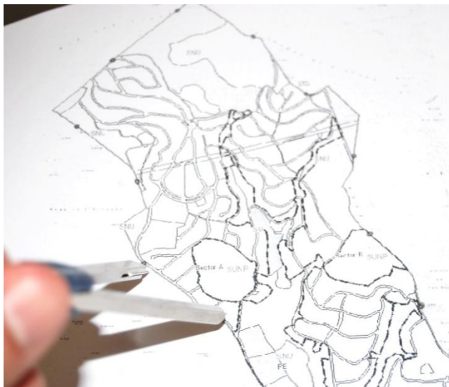
Calculant el perímetre mitjançant el mètode del compàs
