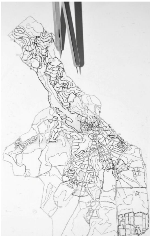
Calculant el perímetre, d'un altre mapa, mitjançant el mètode del compàs
