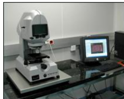
Fig. 29 Interferòmetre: màquina que estudia la rugositat dels materials, situada al Parc Científic de Barcelona.
