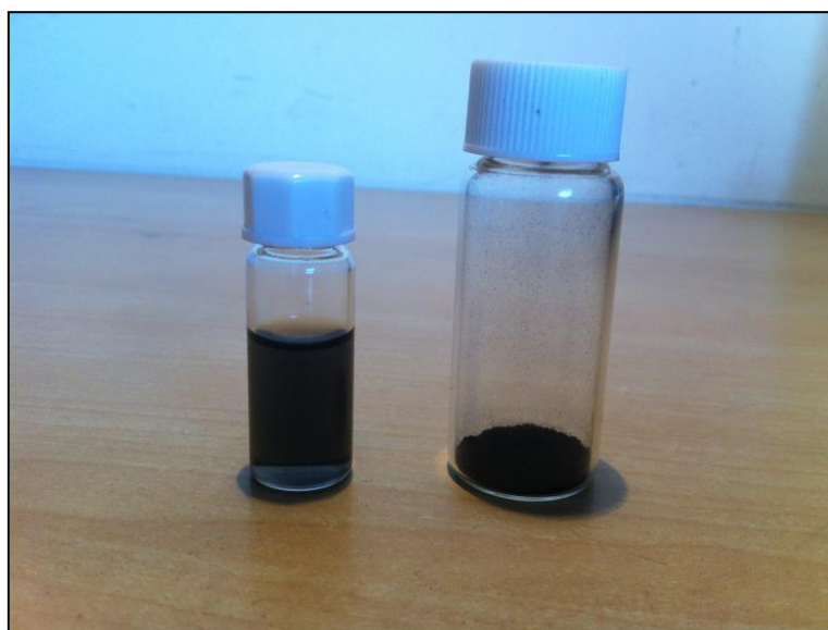
Imatge 34: Les dues mostres que em va proporcionar el Dr. Gómez contenen òxid de grafè (esquerra), que tot i està oxidat conserva la seva transparència, i grafè en pols (dreta).
