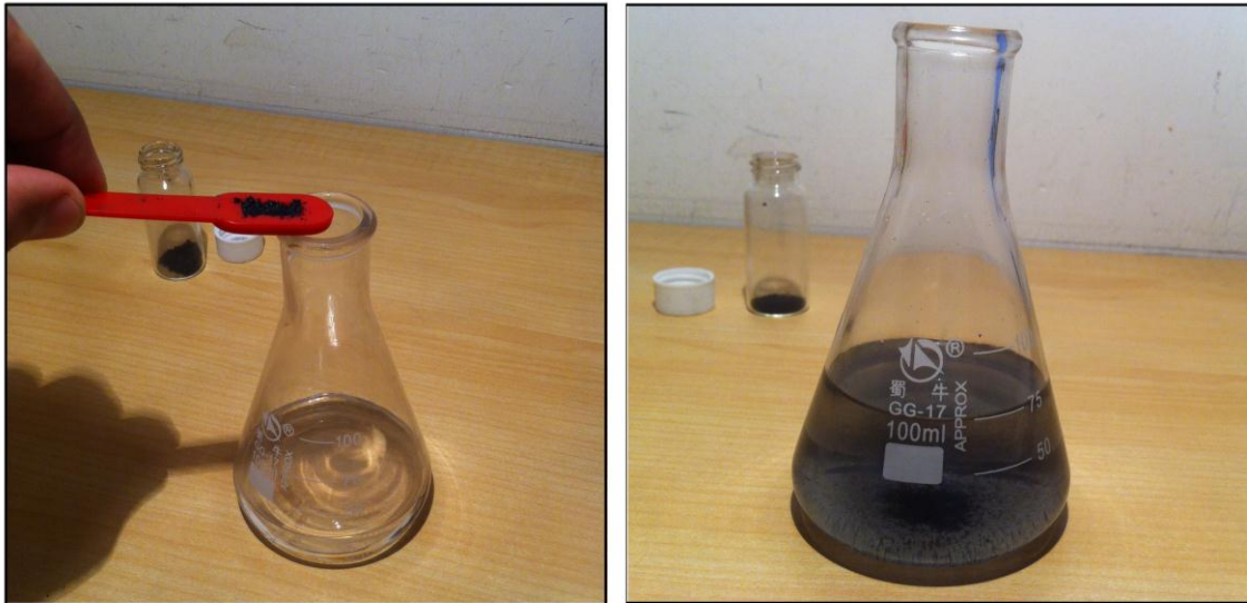
Imatge 35: El grafè en pols va resultar bastant difícil de dissoldre en l'etanol, ja que tot i remenar la mescla durant 15 minuts, el grafè no va acabar de dissoldre's del tot.
