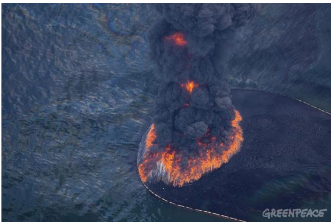
Incendi controlat de l'hidrocarburi amb barrera
