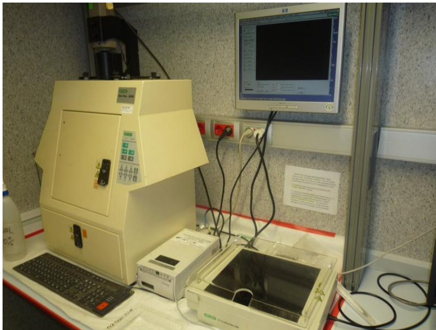
Figura 13: font de llum blanca que permet veure les mostres de DNA amb molta claredat.
