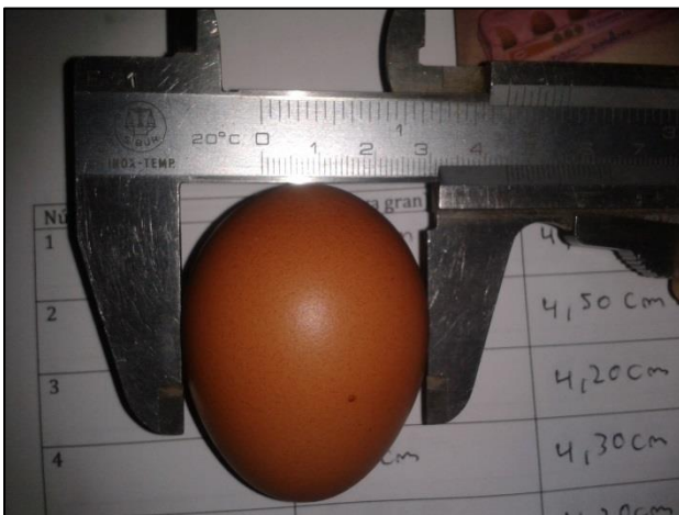
Imatge que mostra com és va mesurar el valor "b" dels ous de gallina amb un peu de rei
