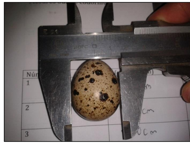
Imatge que mostra com és va mesurar el valor "b" dels ous de codorniu amb un peu de rei
