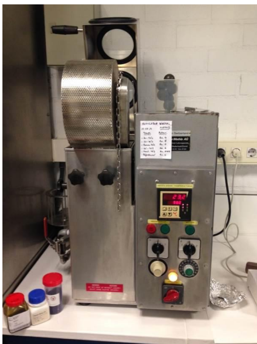
Figura 11. Aparell destinat per tenyir les fibres de niló 6,6 obtingudes en l'empresa Defiber
