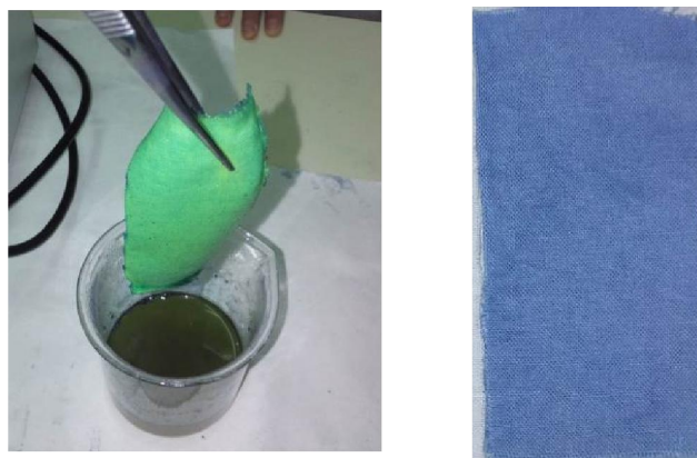
Figura 27. Canvi de color que experimenta la peça de roba quan s'asseca a l'aire.
