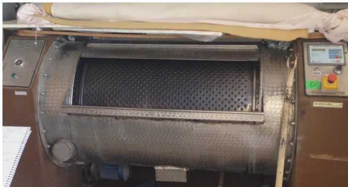
Figura 13. Màquina que utilitzen per tenyir la roba en el taller de tintoreria de l'Espluga del Francolí.
