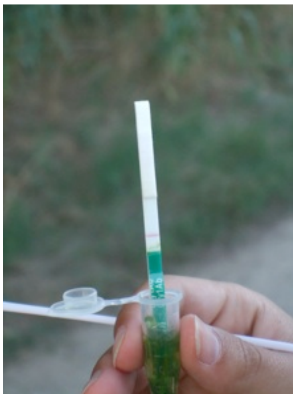
Figura 6.6. Strip que ha donat negatiu en el resultat del test de transgènics, ja que només té una banda vermella.
