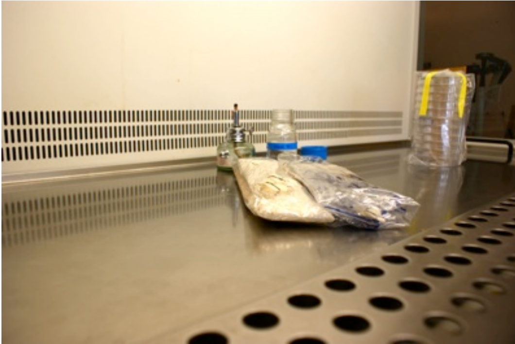
Figura 5.6. El material que es necessitarà es col·loca ordenadament a la taula de treball de sota la campana d'extracció per treballar-hi. Tot ha de ser estèril, ja que sinó es podrien contaminar els calls que s'estan preparant; les pinces s'han esterilitzat prèviament amb altes temperatures, i no obrirem l'empaquetatge que les conté fins just abans de l'operació, a sota mateix de la campana.
