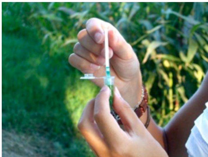
Figura 6.5. Manteniment durant quatre minuts de l'strip a dins la mostra.
