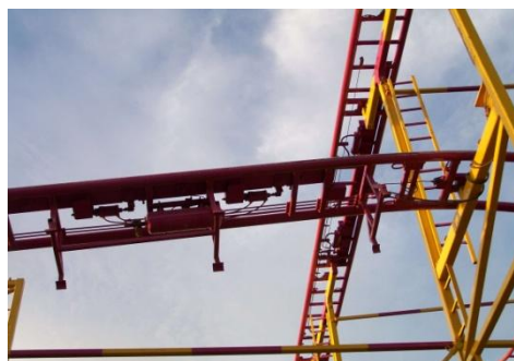
Frens de seguretat col·locats a la meitat del recorregut. Imatge extreta de "commons.wikimedia.org"
