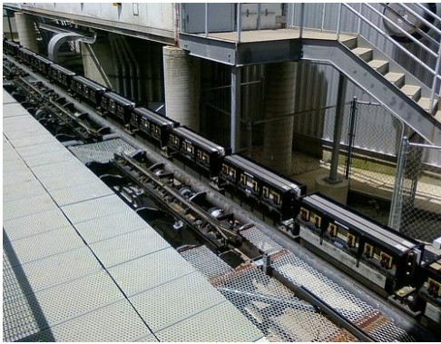
Electroimants (LIM) posats a una banda de la via. Imatge extreta de forum.nolimits-exchange.com
