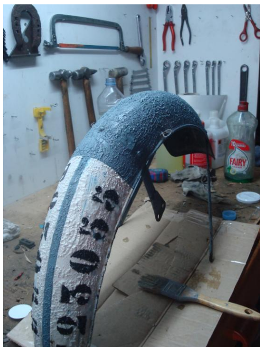
Foto 3: Efecte del decapant
