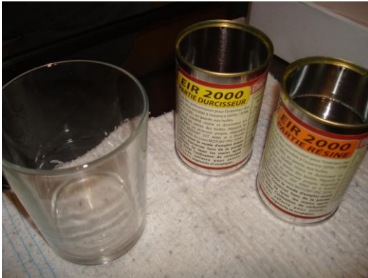
Foto 34: Els dos components de la resina epoxi
