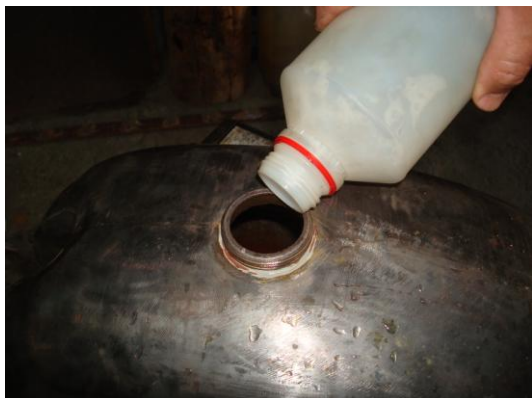
Foto 30: Aplicant i escampant l'àcid per l'interior del dipòsit
