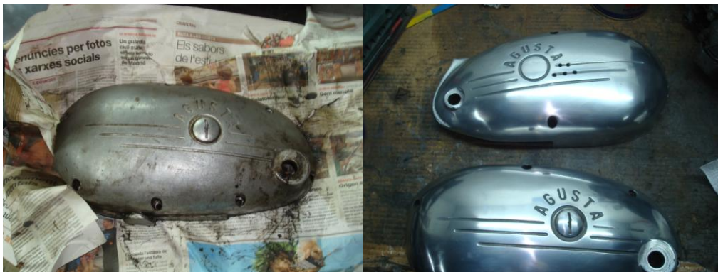
Foto 74: Abans i després de polir les tapes del motor
