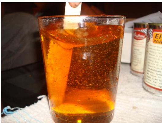
Foto 35: Mesclant els components de la resina epoxi i posant-la al dipòsit
