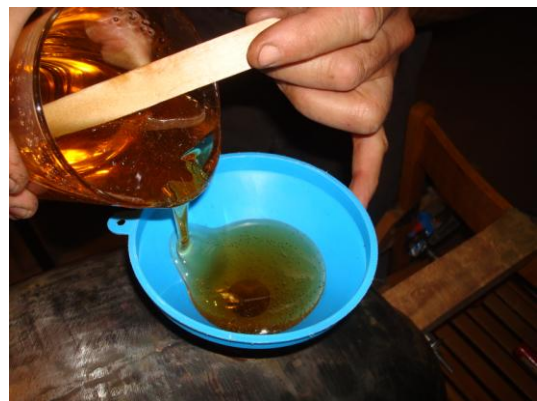
Foto 35: Mesclant els components de la resina epoxi i posant-la al dipòsit
