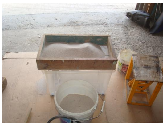
Foto 95: Preparant per arenar: filtratge de l'arena
