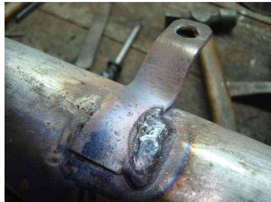
Foto 54: Platina nova soldada al silenciador
