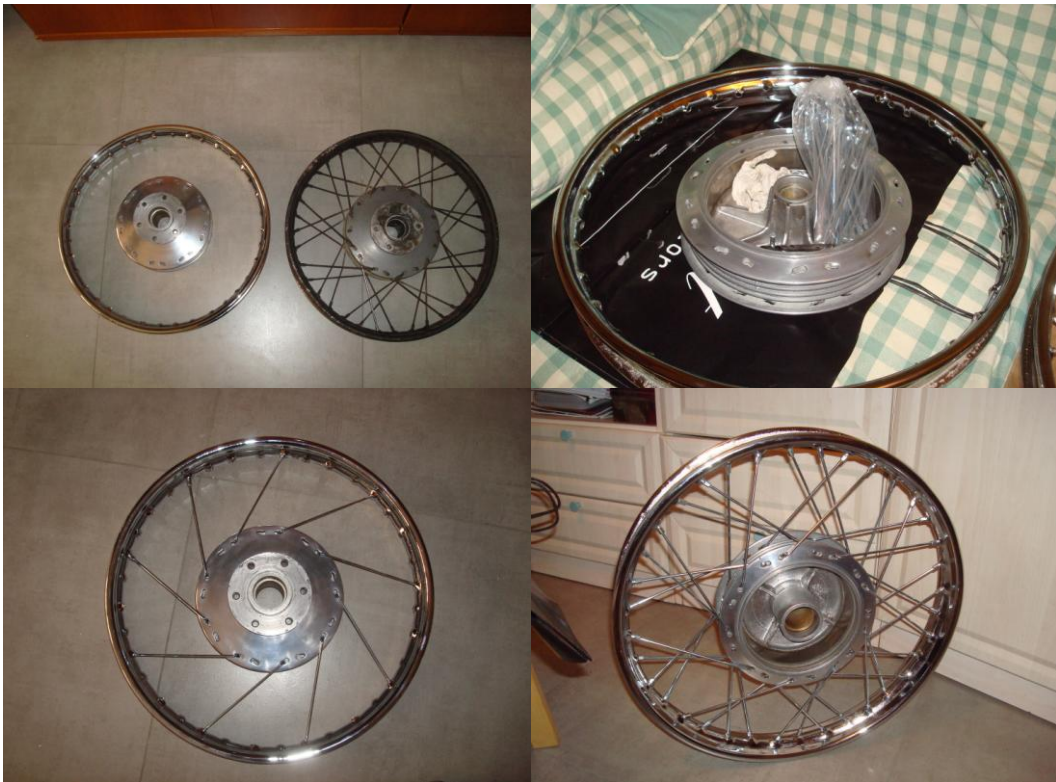
Foto 59: Muntatge de les llantes a falta de radiar
