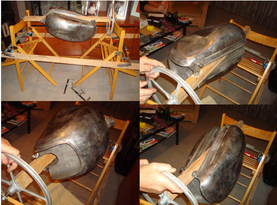
Foto 36: Aplicant la resina epoxi pel dipòsit
