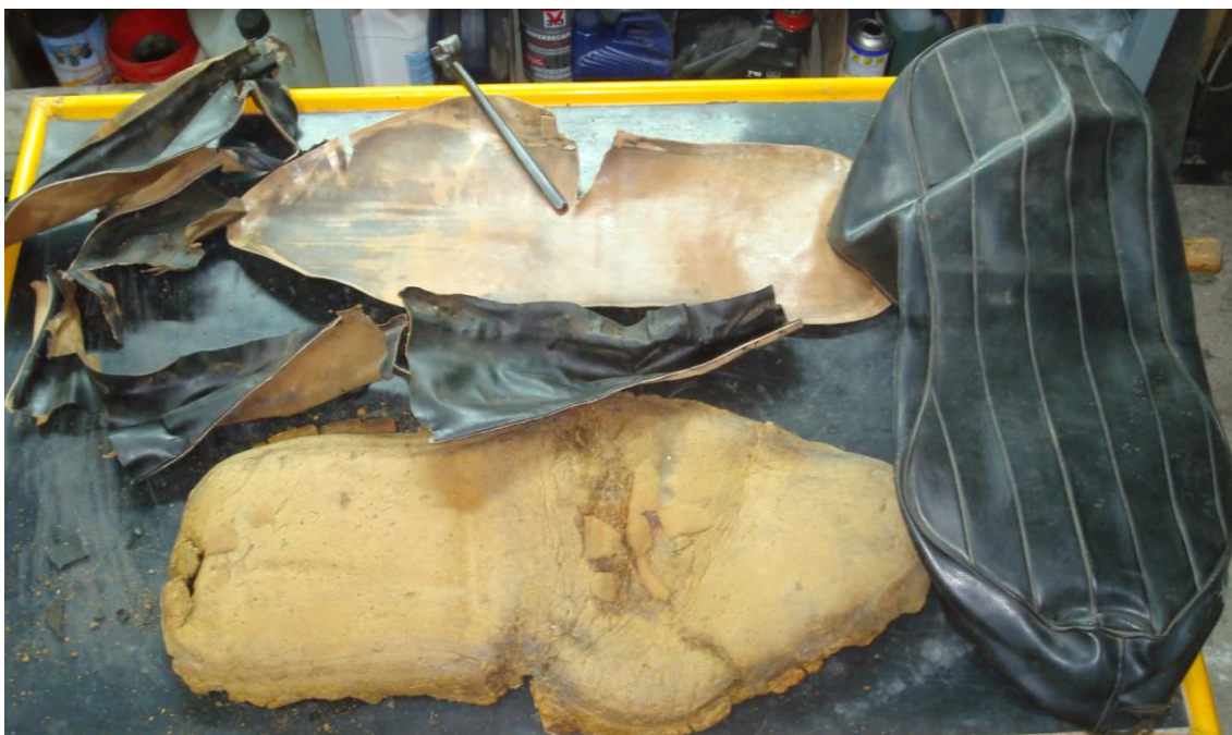
Foto 63: Espuma, entapissat i funda deteriorats
