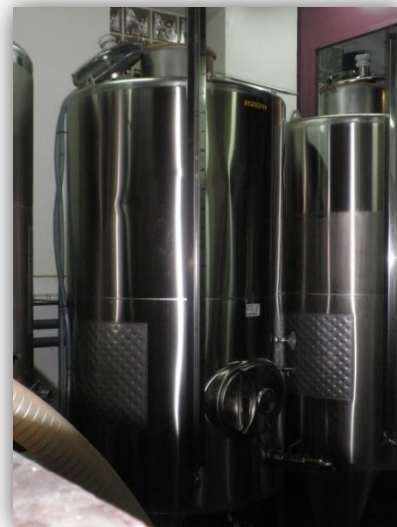
Dipòsit de fermentació* amb sistema de refrigeració
