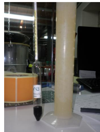
Densímetre utilitzat per mesurar i controlar la densitat del most*.
