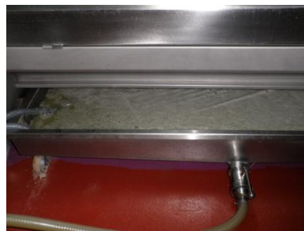
Most* acabat de premsar* que passarà per mitjà del tub de la imatge, cap a la tina*.
