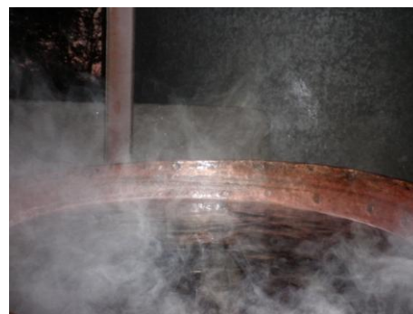
Most* en plena ebullició, s'hi observa una considerable disminució del volum del most* degut a l'evaporació de l'aigua.
