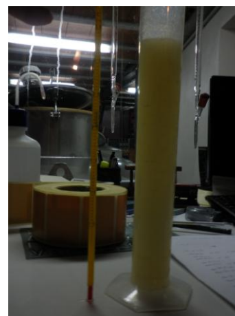
Termòmetre utilitzat per mesurar i controlar la temperatura del most*.
