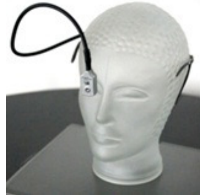
Imatge extreta de https://es.wikipedia.org/wiki/Eyeborg . Representa l'aparell que permet veure els colors a través de l'oïda, l'eyeborg
