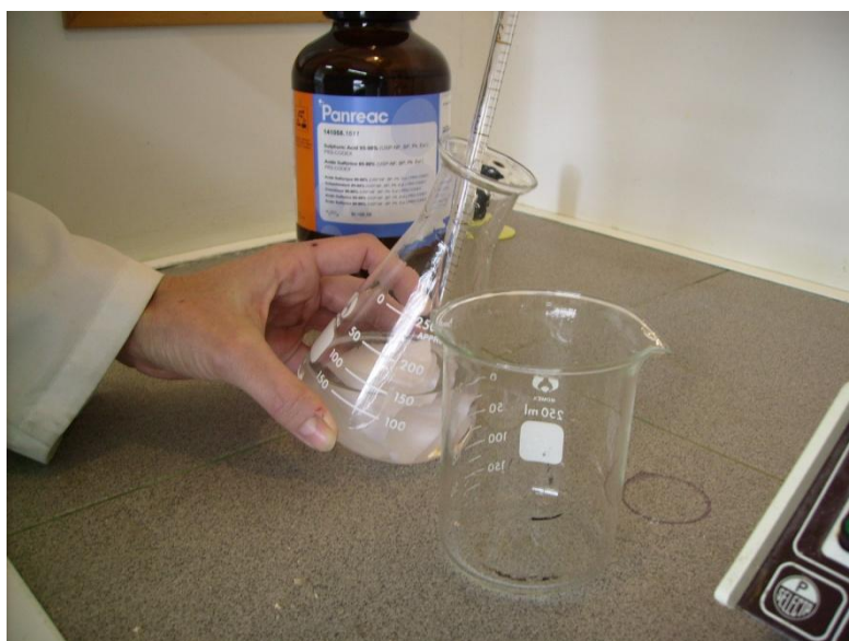
Erlenmeyer després de la filtració i paper de filtre dins d'un altre Erlenmeyer.
