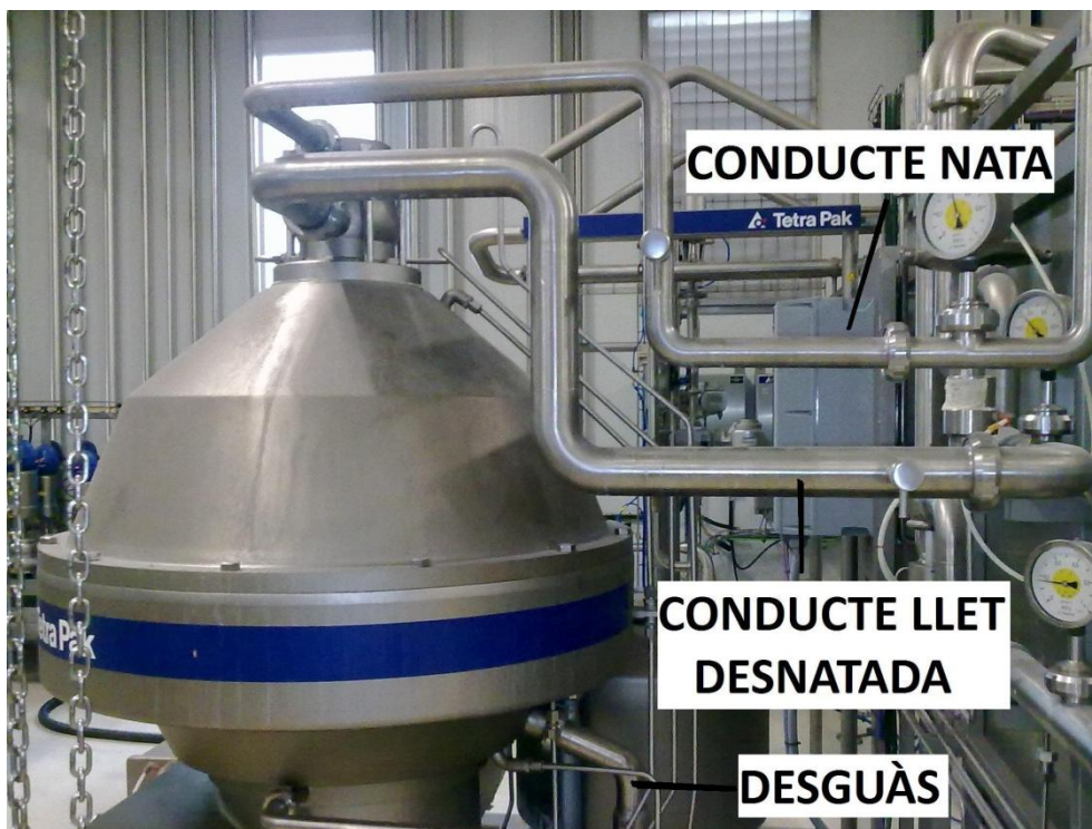
Desnatadora amb els tres conductes anomenada Tetra Centri de la marca TetraPak.
