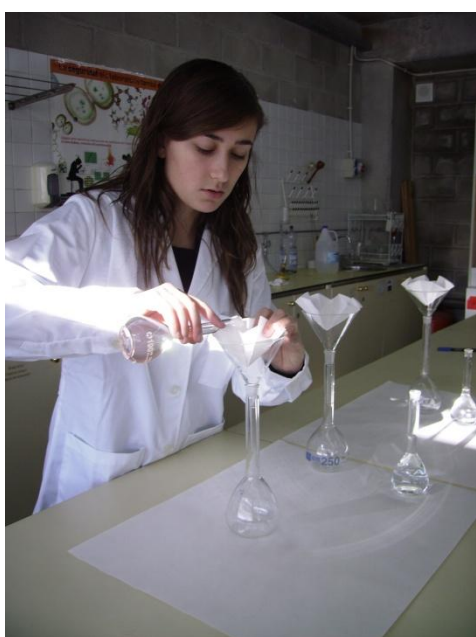
A l'esquerra, filtrant el contingut del matràs de 100 ml. I a la dreta, aforant amb aigua destil·lada fins als 250 ml.
