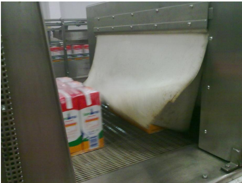
Pacs sortint del forn on s'ha dut a terme la retractilació del film.
