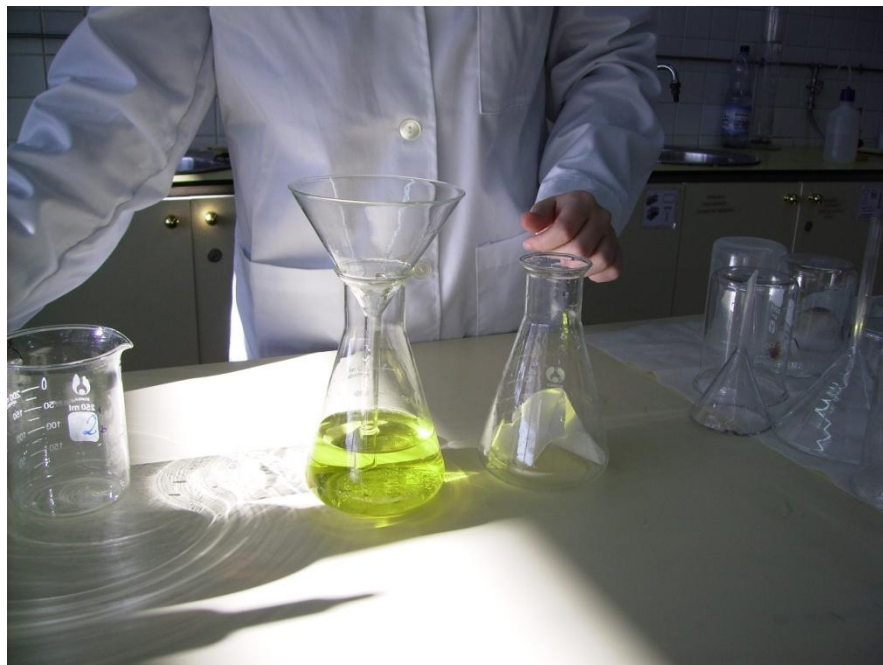
Erlenmeyer després de la filtració i paper de filtre dins d'un altre Erlenmeyer.
