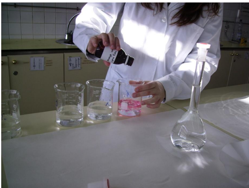
Afegint les gotes de l'indicador roig de metil a un vas de precipitats.
