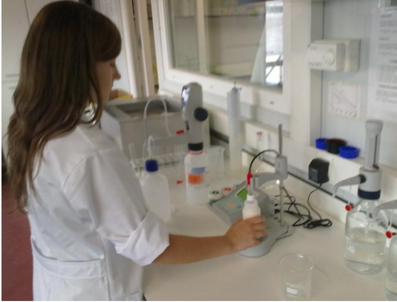
Agitant la mostra per obtenir el pH mitjançant un pH-metre.
