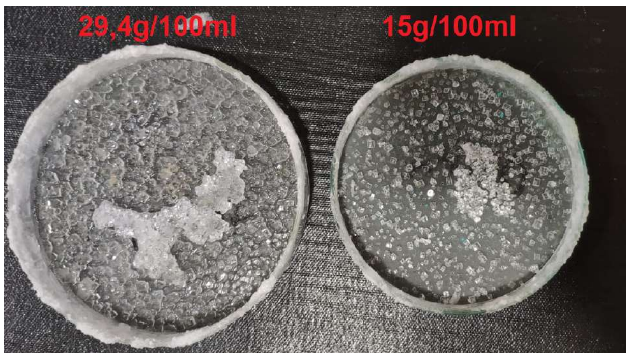
Fig. 35 Comparació entre els cristalls de dissolucions de diferent de concentració
