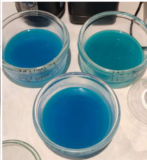
Fig. 58 Cristal·litzadors amb una dissolució de sulfat de coure amb aigua
