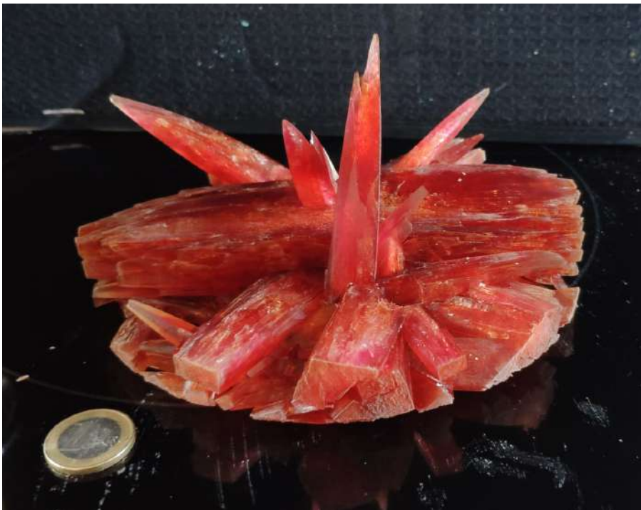
Fig. 61 Tercer cristall gran amb una concentració de 1575g/2500ml
