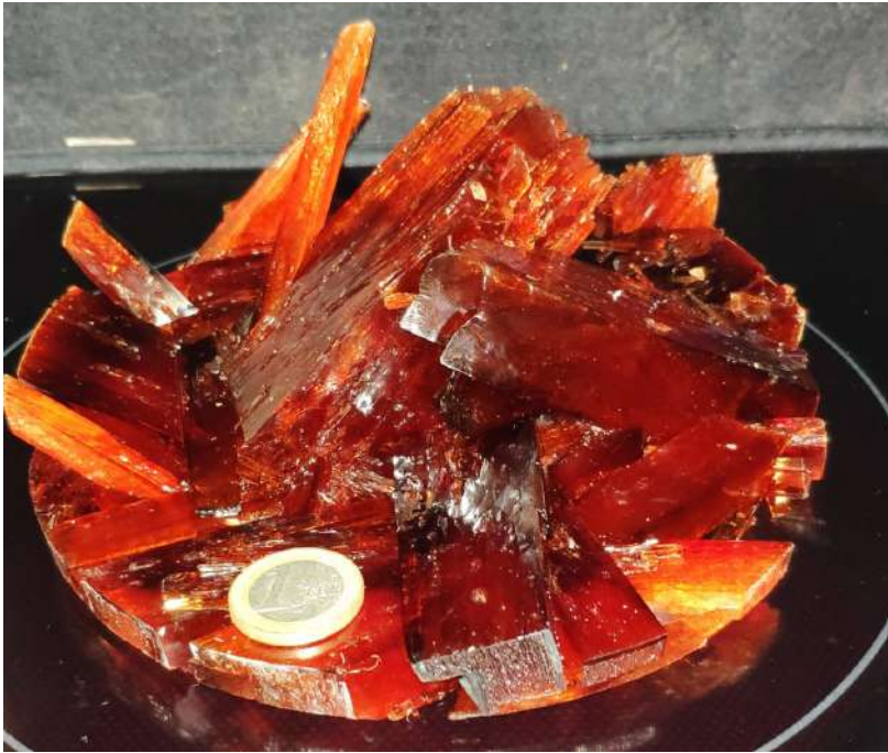
Fig. 64 Sisè cristall gran amb una concentració de 1700g/3000ml
