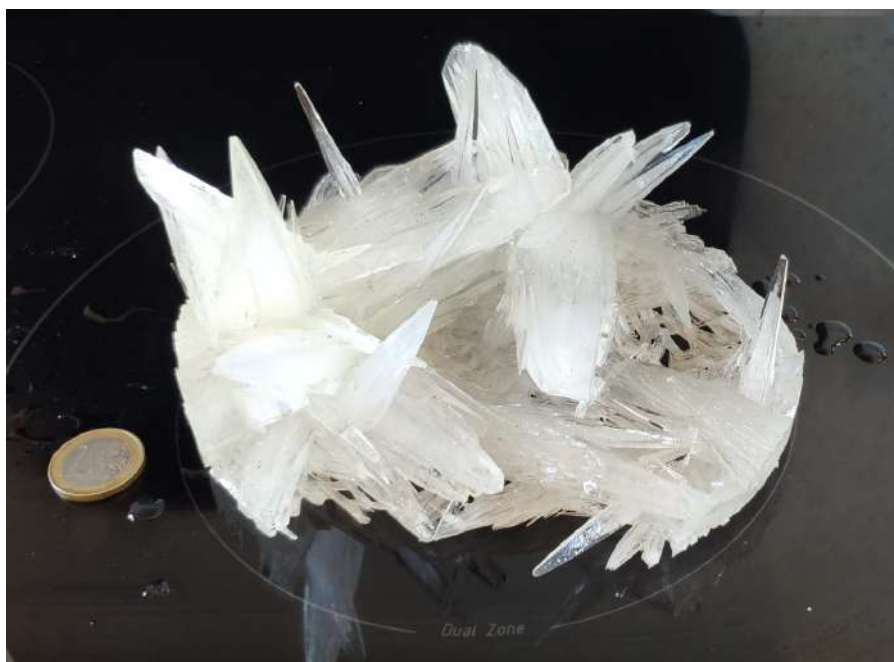
Fig. 59 Primer cristall gran amb una concentració de 1500g/2500ml
