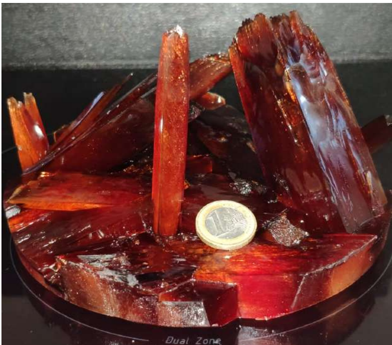
Fig. 65 Setè cristall gran amb una concentració de 1800g/3000ml
