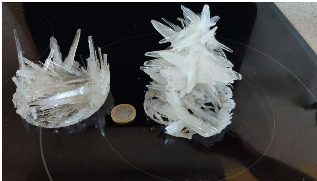
Fig. 46 Cristalls obtinguts a partir de dues dissolucions de diferent concentració
