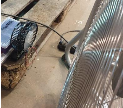
Fig. 6.3 Aerogenerador en funcionament (vent de 20 km/h) (Font pròpia).
