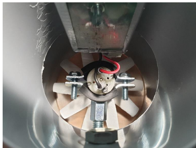
Fig. 9.2 Motor col·locat al seu suport i connectat a la placa step-up (Font pròpia).
