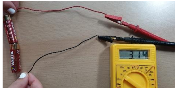
Fig. 6.5 Mesurem les dues piles en sèrie (3,14V) (Font pròpia).
