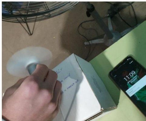
Fig. 8.3 Comprovació de la càrrega de l'aerogenerador. El mòbil es carrega (Font pròpia).
