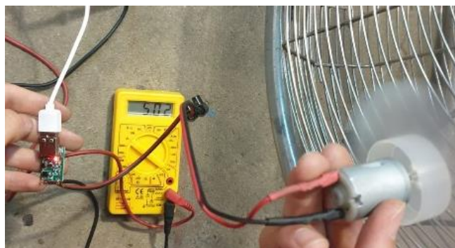
Fig. 6.7 Aerogenerador generant 5,02 V (Font pròpia).
