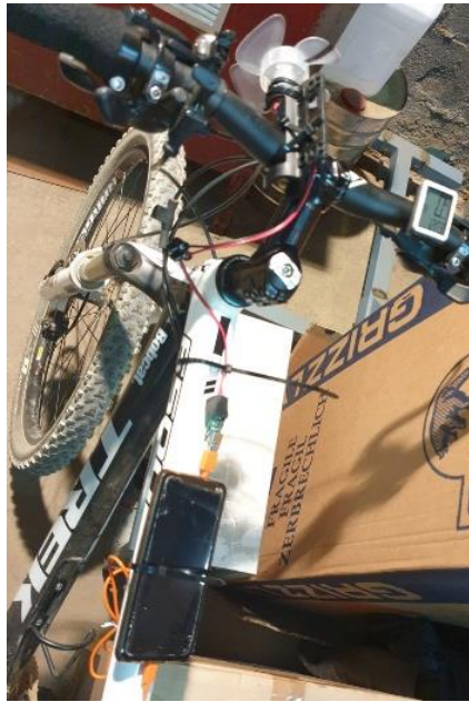
Fig. 6.8 L'aerogenerador instal·lat a la bicicleta, preparat per carregar el mòbil quan funcioni (Font pròpia).
