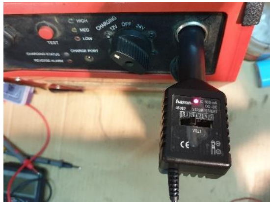
Fig. 6.5 Transformador (regulat a 3 V) connectat a un arrencador de cotxe de 12V (Font pròpia)
