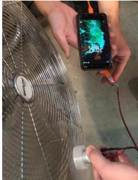
Fig. 6.7 L'aerogenerador aconsegueix carregar el mòbil quan treballa (Font pròpia).
