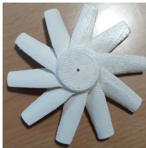
Fig. 8.1 Pala 3D “bona” (Font pròpia).
