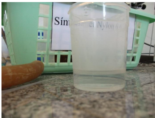
Fig. 23. Apareix nyló a la interfase dels dos líquids. (Universitat de Girona)
