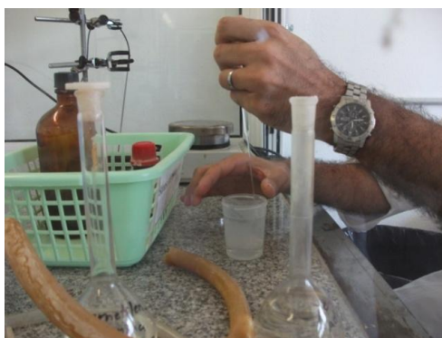
Fig. 22. Barreja d'àcid adípic a l'hidròxid sòdic, inici de la policondensació.(Universitat de Girona)
