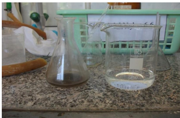
Fig. 21. Addició de clorur d'adipoilo a l'hexà. Obtenció d'àcid adípic.(Universitat de Girona)
