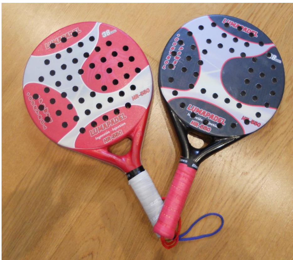
Foto 18. Pales foradades, el grip col·locat i la imatge empegada en les dues cares.
