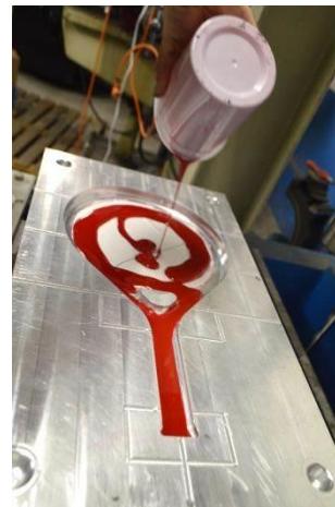
Foto 9. S'aboca la injecció en el motlle.
