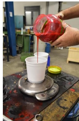
Foto 7. S'aboca el tint vermell al polipropilè.
