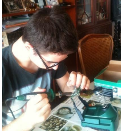
Fig. 65: Procés de la soldadura de components a la placa base.
