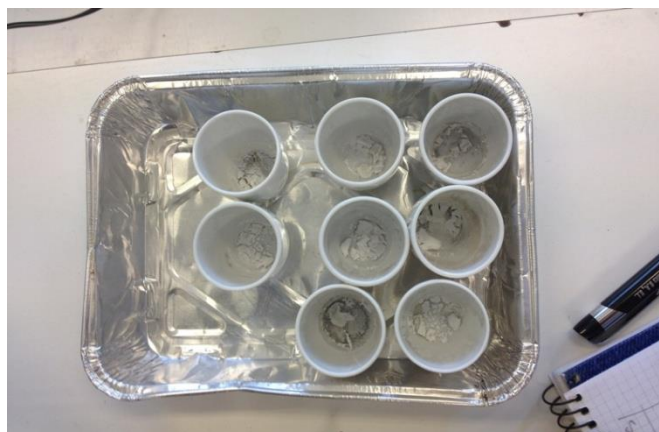
Foto 16: Càpsules amb les mostres transformades en cendres després de la dessecació.
