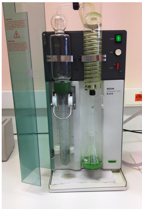
Foto 20: Destil·lador amb les mostres recollides al final de la destil·lació.
