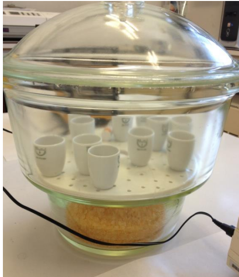
Foto 12: Càpsules amb les mostres dins el dessecador per l'obtenció dels sòlids totals.
