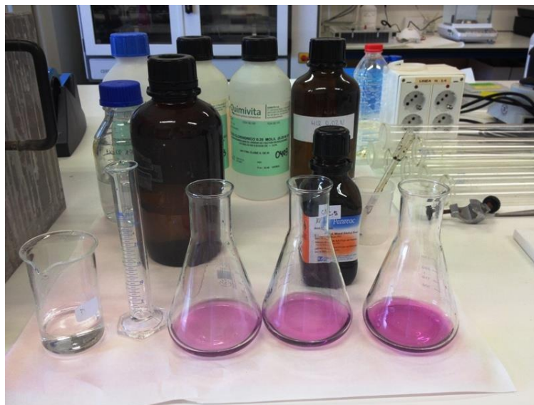
Foto 18: Materials i reactius per a dur a terme la destil·lació del mètode Kjeldhal.
