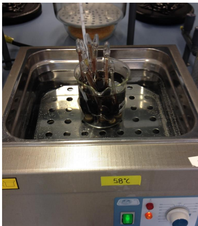
Foto 10: Col·locació en repòs de les mostres al bany maria del mètode Gerber.
