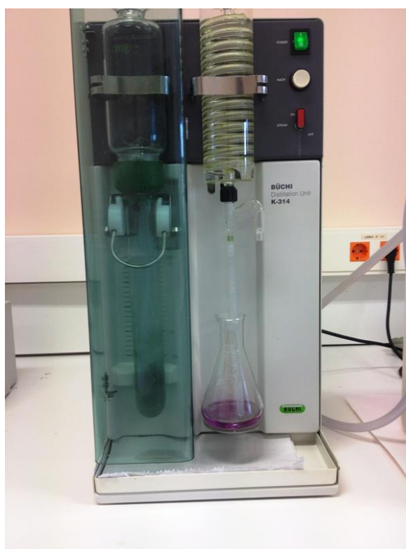
Foto 19: Destil·lador amb les mostres just al principi del procés de destil·lació.
