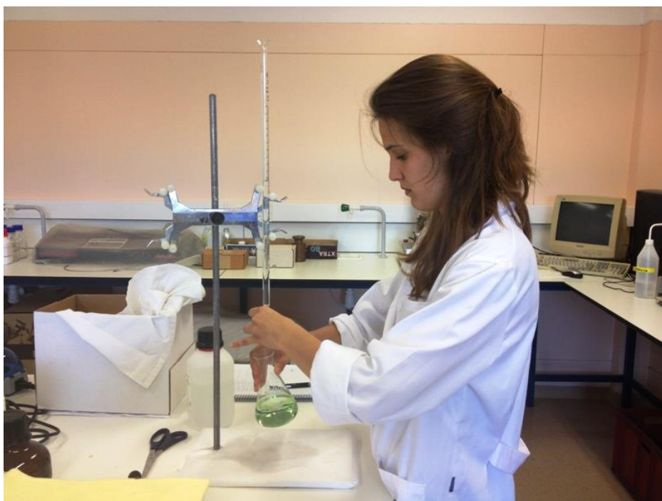
Foto 21: Fent una valoració àcid base pel mètode Kjeldhal.
