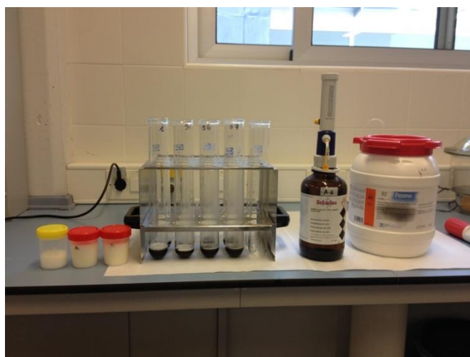
Foto 17: Mostres amb els materials i reactius preparats just abans de la digestió del mètode Kjeldhal.
