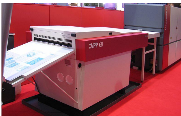
Fig. 1: Dispositiu d'impressió directament a la placa de la casa AGFA. Utilitza un làser violeta per a la generació de la placa litogràfica.
