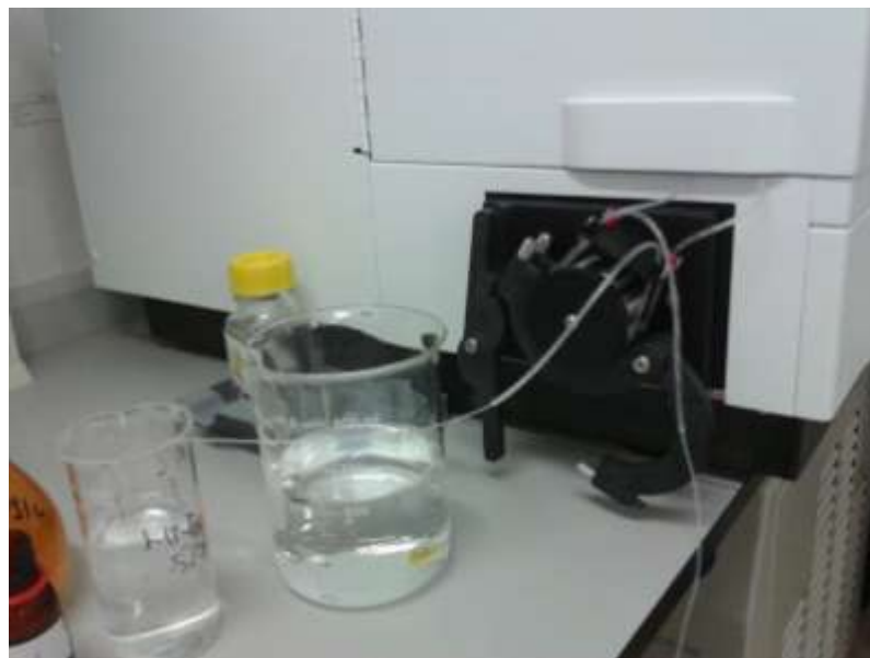
Figura 31. Detall d'introducció de mostres a l'espectrofotòmetre d'emissió atòmica
