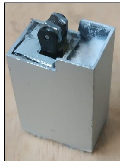
Il·lustració 43: Encenedor de metanol (completament acabat)
