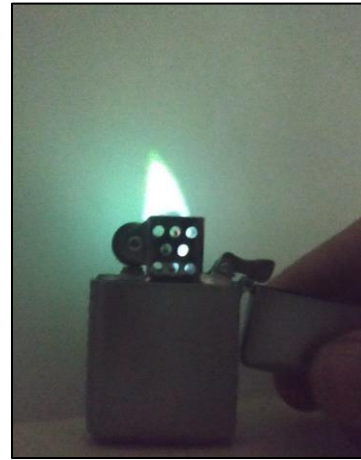
Il·lustració 23: Flama del Zippo amb la dissolució de l'11% amb un ambient il·luminós
