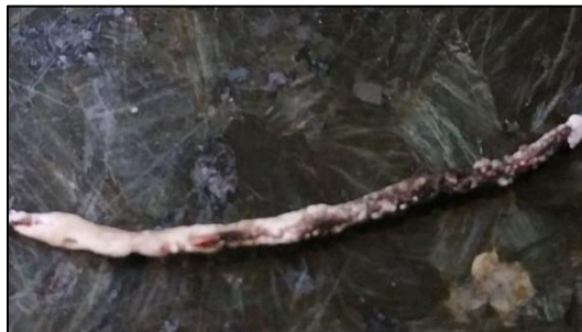
Il·lustració 30: Fil de Coure on s'aprecia la diferencia entre la zona cremada amb sutge i la part intacta
