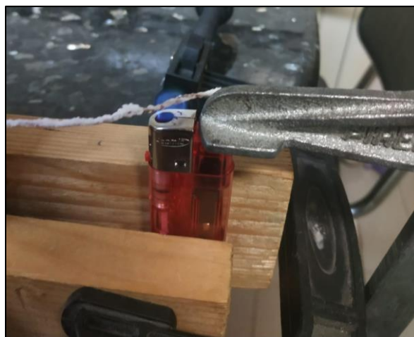
Il·lustració 28: Muntatge de la prova on s'aprecia el fil de coure recobert d'àcid bòric
