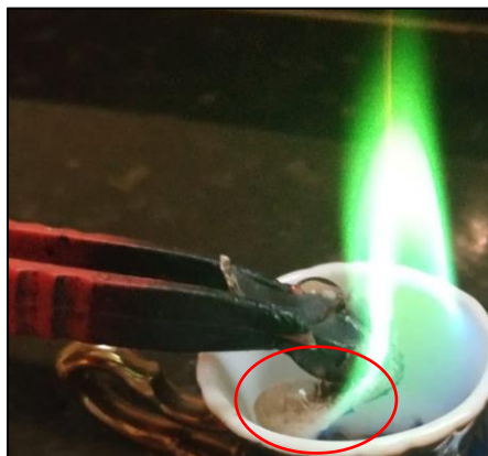
Il·lustració 33: "Pedra" d'àcid bòric sota la flama, on s'aprecia com aquesta es desfà degut a l'alta temperatura
