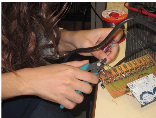
Pelant els cables de colors corresponents a cada forat i a cada pin
