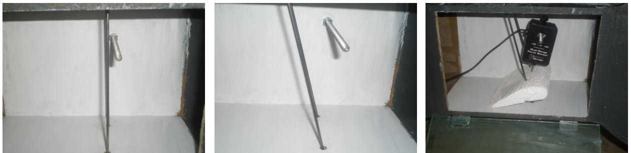
Imatges de la secció de prova. El la foto de l'esquerra es mostra com queda col·locat el dinamòmetre per mesurar la força de sustentació del perfil alar
