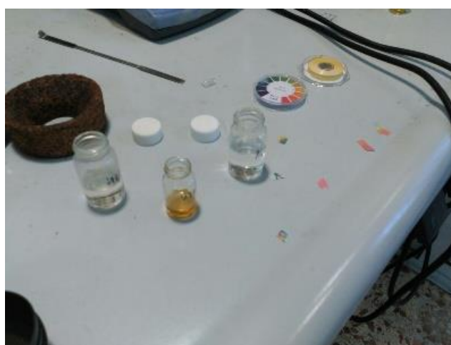
Figura 29: Marcadors de pH, dissolució de sosa i d'àcid clorhídric i mostra líquida.
